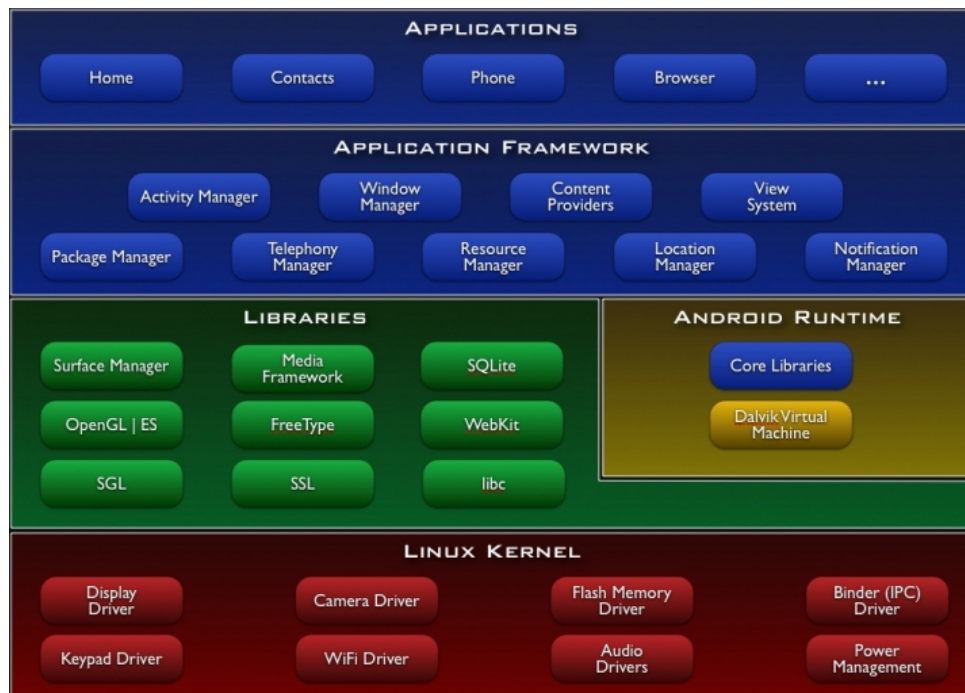
(A) Visione High-Level dell'Architettura di Android. http://androidteam.googlecode.com/files/system-architecture.jpg
