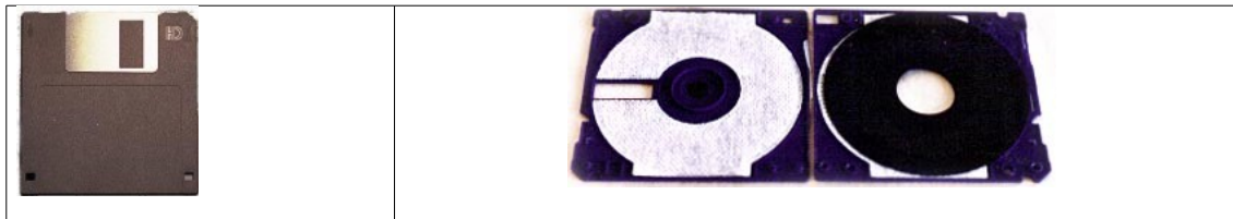
Figura 15-2: Un floppy disk all'esterno appare come un parallelepipedo dallo stretto spessore e di base quadrata (a). All'interno è presente un disco di plastica contenente l'informazione (b), due superfici morbide separano il disco dall'involucro per evitare che possa venire graffiato.
