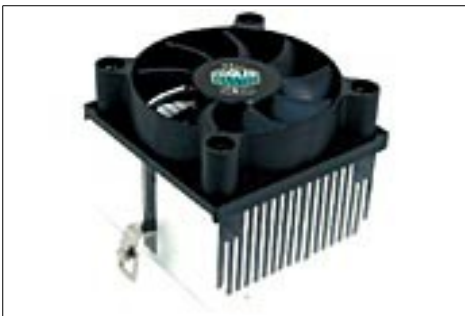
Figura 9-2: Ventola per processori; è composta da due parti: 1. la parte metallica è composta da una serie di lamine che servono a disperdere il calore dalla superficie del processore. 2. la ventola vera e propria che disperde il calore dalle lamine.
