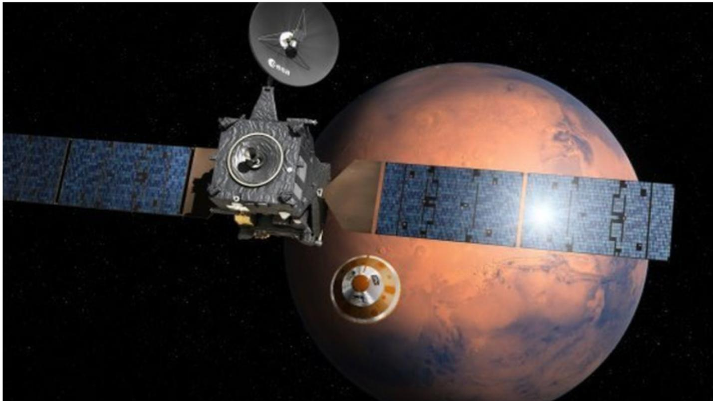
La missione **ExoMars**, finanziata da **Europa** e **Russia**, potrebbe aver fallito a causa di un errore di programmazione. Errore che ha causato lo **schianto della sonda Schiaparelli sulla superficie di Marte** la scorsa settimana. Stando a quanto riportato da **Nature**, probabilmente il software ha ingannato la sonda facendole credere di essere atterrata prima del previsto sulla superficie del pianeta rosso. Il difetto di sistema avrebbe poi condotto la sonda allo schianto.
